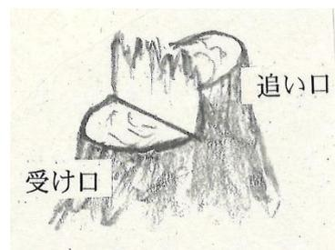
※ 傾斜地で伐ることから追い口が斜面傾斜と同じ斜めになっている例が見られます。伐倒作業上は楽でしょうが、つるが機能しない、伐倒方向が安定しないなどの危険性があります。
